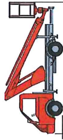
Camion nacelle Occupant 20m 2 au sol
